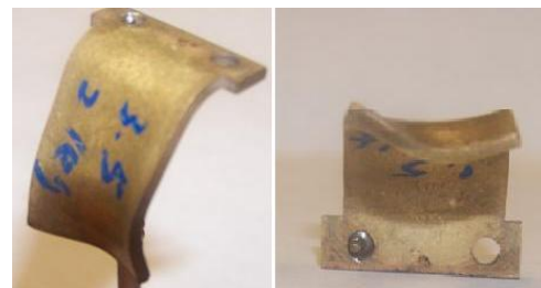
Figure 11 : EM Non uniform flanging of 1.588mm specimen.
